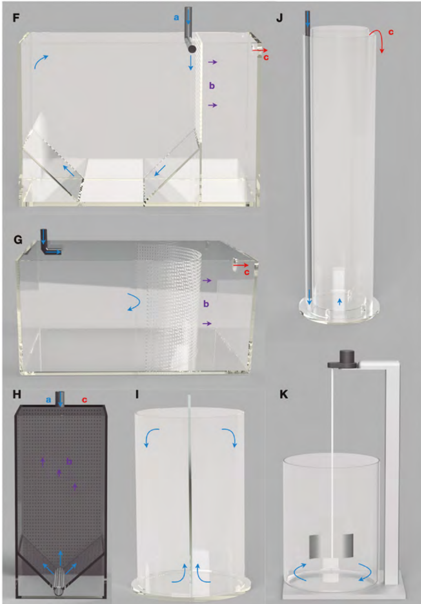
FIGURA 3 (CONTINUACIÓN). F Tanque rectangular; G Tanque rectangular de captación de éfiras ( Rectangular Screened Flow-Through Tank ); H Tanque con fondo en V; I Tanque cilíndrico; J Sistema de tubos de difusión; K Tanque con dispositivo de rotación; a Impulsión; b Malla de salida; c Desborde. Las flechas azules indican la entrada de agua y el flujo principal. Las flechas rojas indican la salida del agua del compartimento principal. Las flechas moradas indican el agua pasando a través de una malla. Imágenes: Alexandre Jan.
