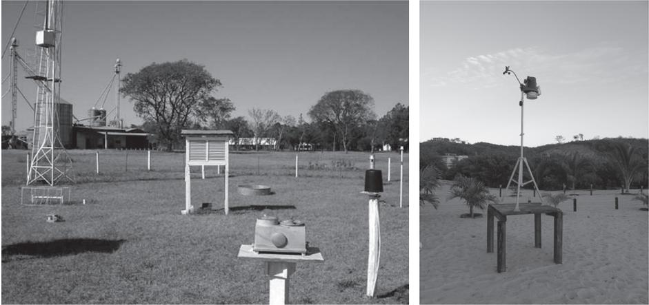
**Figura 7.3.** Ejemplo de una estación climática tradicional (izquierda) y una estación meteorológica automática (derecha)
