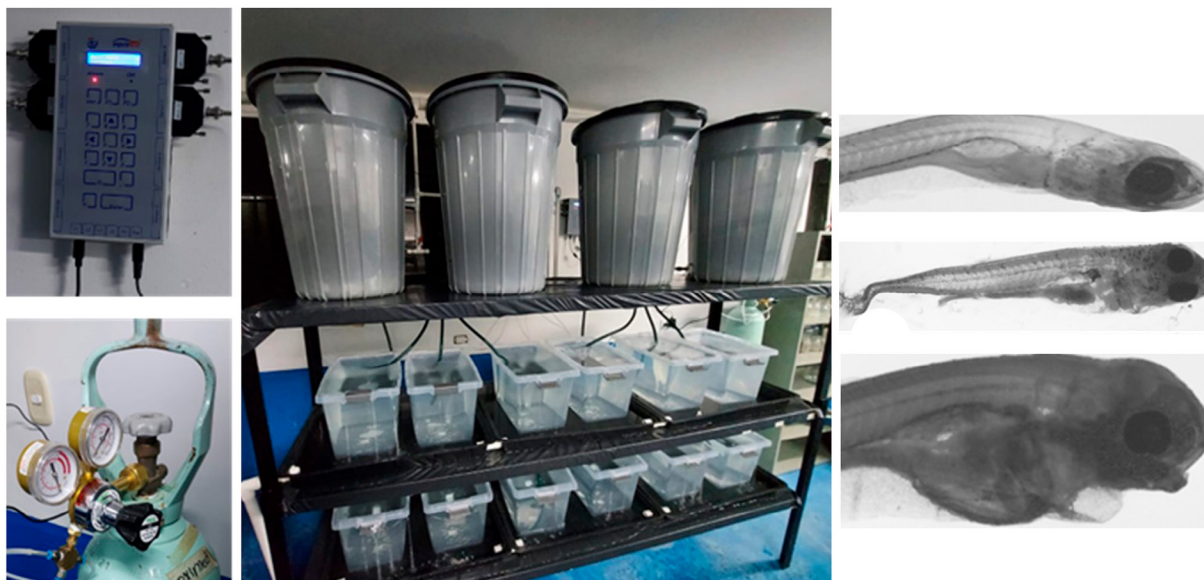
Fig. 20. Estudio de la acidificación sobre el desarrollo temprano del bocachico P. magdalenae con control automatizado de variables (IKS, Aquastar) 1 .
