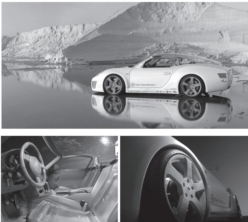
**Figura 25.** Prototipo de automóvil deportivo "zaZen", desarrollado por Rinspeed y Bayer Material Science. El uso exploratorio del plástico en este auto predice el uso de este material en los próximos años: cúpula del techo y armazones de los asientos transparentes y ligeros, luz de freno holográfica, recubrimiento de poliuretano autocurativo, asientos con cojines de gel transparente y rines en polímero ultra-resistente (2008).
