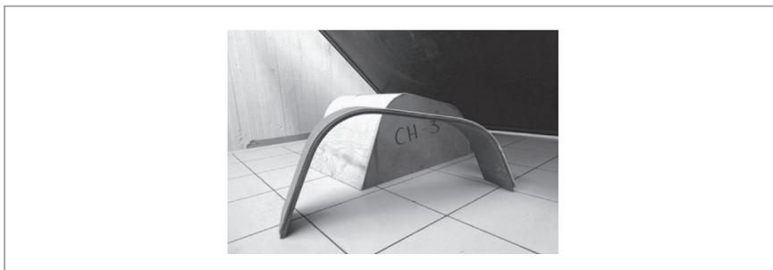
**Figura 43.** Muestra de curvado de cartón y *triplay* de 3 mm espesor.
