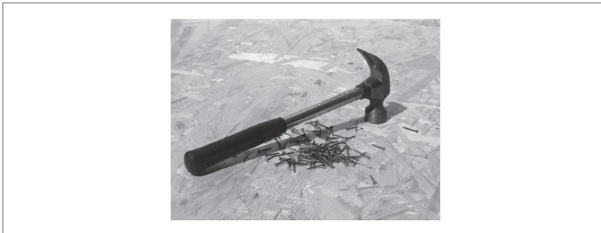
**Figura 52.** Ejemplo de herramienta al cual se le ha colocado un recubrimiento “suave” para mejorar el agarre; sin embargo, este mango tiende a moverse con el movimiento por estar superpuesto. Fuente: Imagen tomada del sitio tOrange.biz: <http://espanol.torange.biz/Objects/Metallic-objects/Martillo-carpintero-2588.html> (24 de febrero de 2013).
