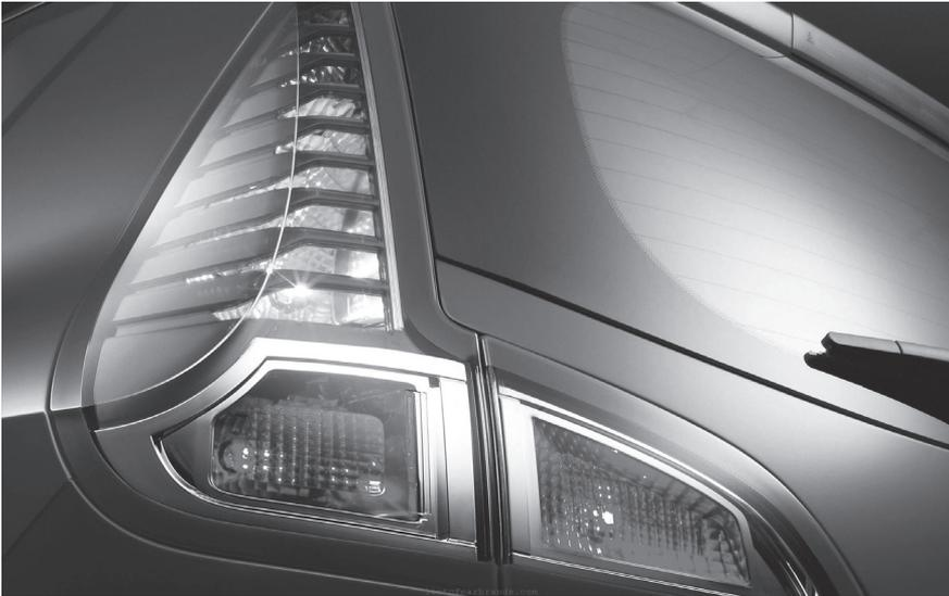
**Figura 21.** Luces traseras Renault Scenic 2010, inyección multicomponente en 3 colores y sobreinyección.
