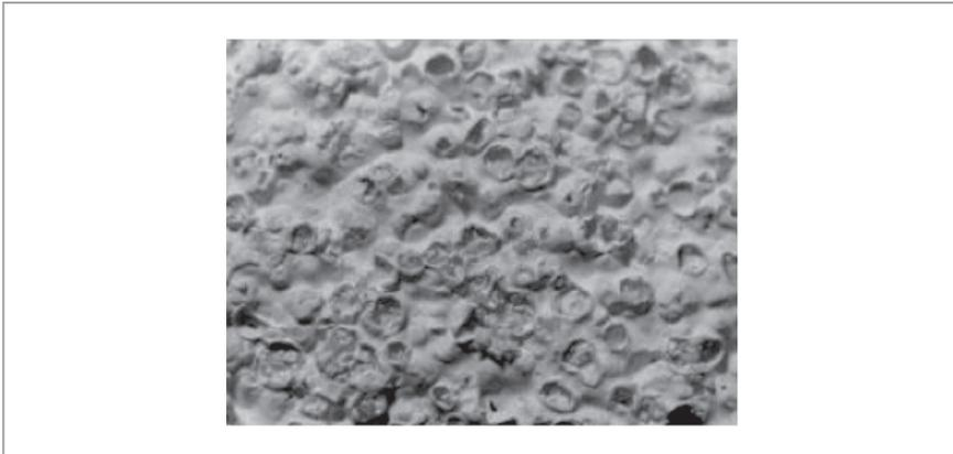
**Figura 48.** Detalle de la superficie de una placa ensayada (fórmula número 3), donde se observan las cavidades que dejan las perlas de EPS después de ser expuestas al calor intenso. Fuente: Fotografía tomada por Francisco Javier González Madariaga.
