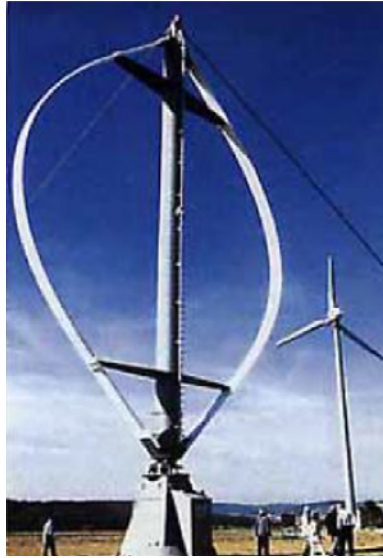
Figura 2.5. Aerogenerador de eje vertical Darrieus. Fuente: Antezana Núñez (2004).
