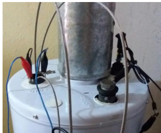
Figura 3. Conexiones de ánodos al termotanque
