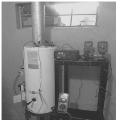
Figura 1. Disposición de los elementos de prueba para el calentador de agua
