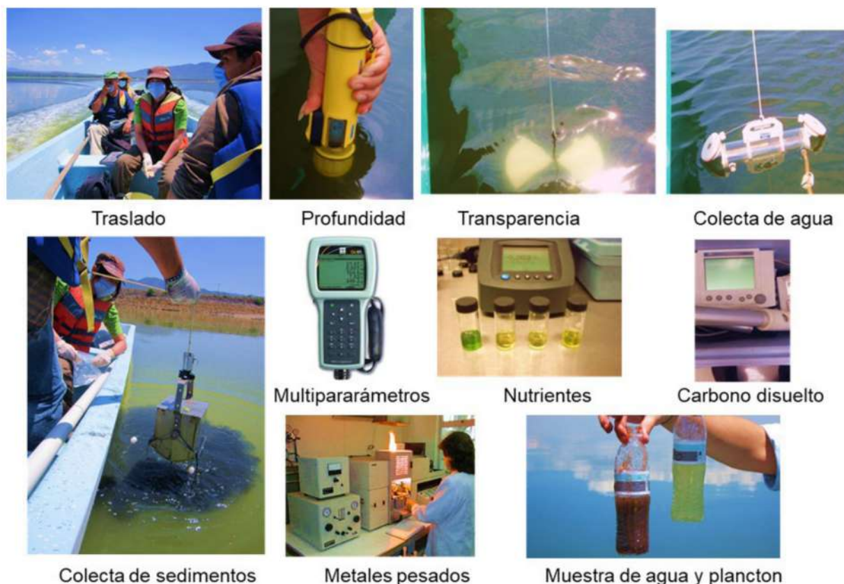
Figura 2. Metodología para evaluar hidrología, calidad del agua y contaminación
