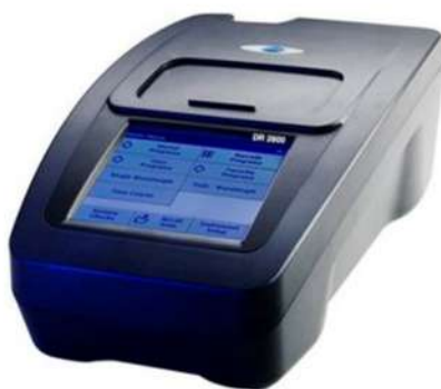
Figura 8. Espectrofotómetro modelo DR 2800
