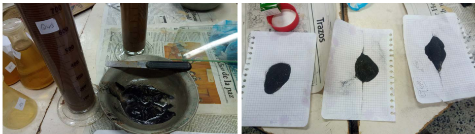
Figura 3. Recolección de magnetita a partir de las muestras decantadas provenientes del ensayo de Bouyoucos
