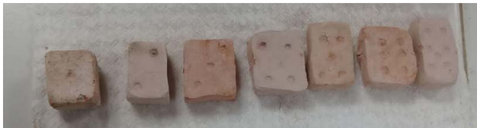
Figura 7. Muestras calcinadas a 900 °C usando lodo rojo residual ácido (7), lodo rojo alcalinizado con solución de cal al 5 % (13), lodo rojo ácido mezclado con bauxita (9, 11 y 12) y lodo rojo alcalinizado mezclado con bauxita (8 y 10)
