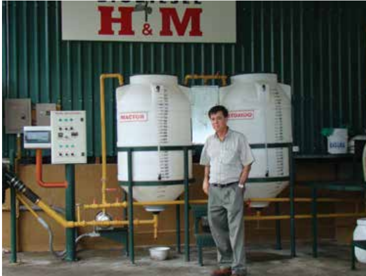
Bioreactores para la elaboración de biodiesel en Los Ángeles de San Ramón, Bajo los Rodríguez, Alajuela.
