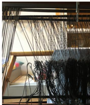
**FIGURA 24.** Proceso de volver a montar la urdimbre.
