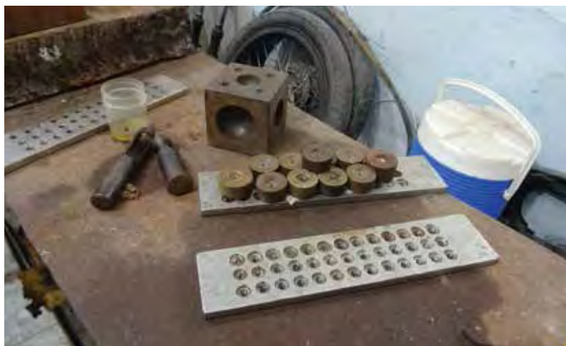
Discos de tungsteno e hileras de acero para estirar el alambre. Foto: Juana Méndez.
