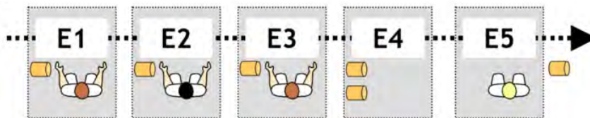
Imagen 6-12. Proceso productivo en el cual existe una restricción o retraso en la etapa 4.
