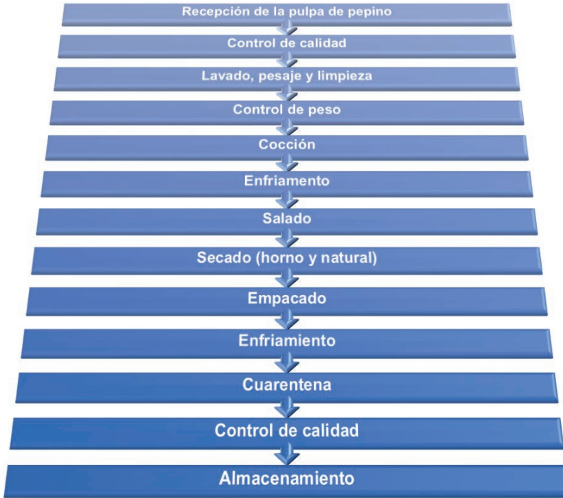
Diagrama 2. Diagrama de proceso para elaboración de pepinos de mar secos y seco-salados
