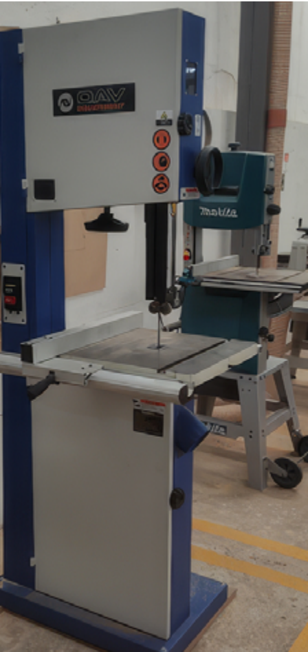
Figura 57. Sierras sin fin contemporáneas marca OAV Equipment (en primer plano) y marca Makita (en segundo plano)
