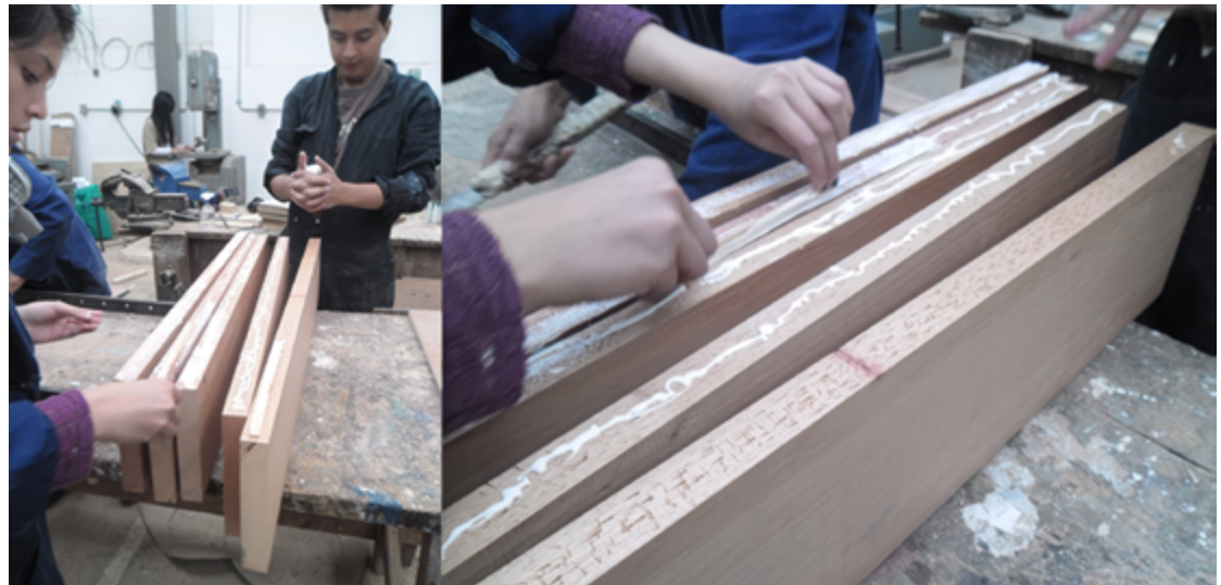
Figura 101. Comienzo del armado de los tableros de pino hayuelo y cedro Puerto Asís
