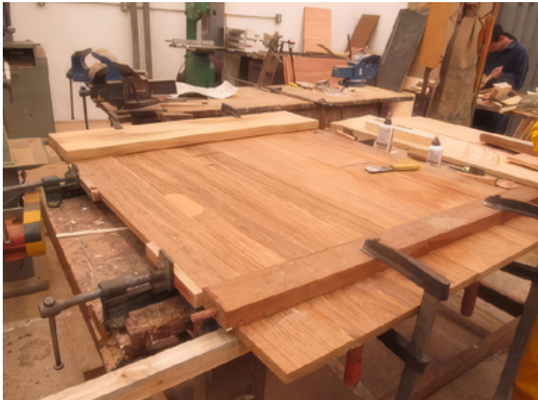
Figura 73. Tableros de madera natural armados
