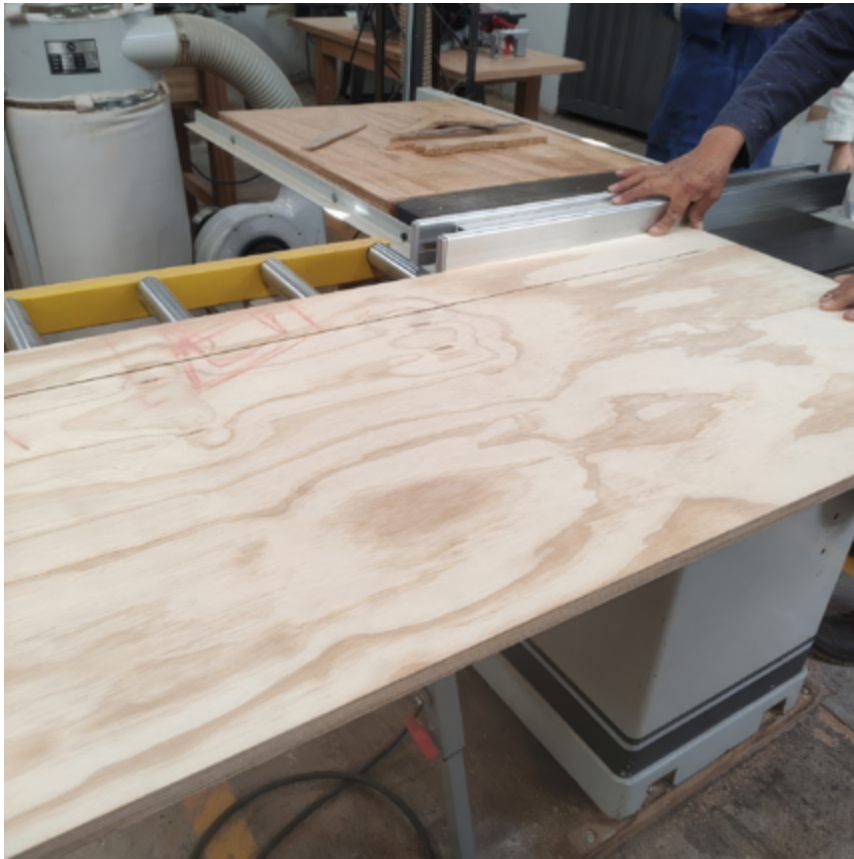
Figura 112. Cortes longitudinales en sierra circular para la elaboración de las partes de la silla prototipo Playita
