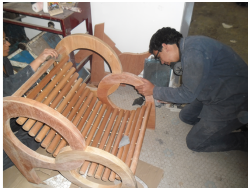
Figura 140. Lijado de superficies de la silla prototipo La Petite
