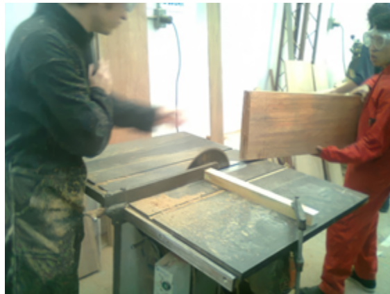
Figura 71. Apertura de bloque de madera realizada por el centro longitudinalmente
