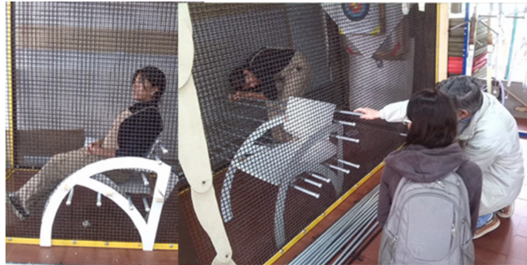
Figura 40. Uso de evaluador postural en el desarrollo antropométrico y ergonómico de la silla prototipo Áurea o Aura
