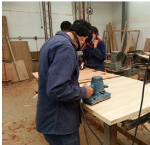
Figura 103. Lijado con lijadoras orbitales de los tableros de pino hayuelo (en primer plano) y cedro Puerto Asís (en el fondo)
