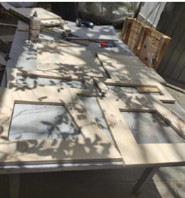
Figura 117. Partes de la silla Hojaldre: dos patas laterales (derecha e izquierda idénticas) asiento y espaldar
