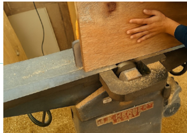
Figura 69. Canteado del canto de un bloque de madera maciza con máquina planeadora
