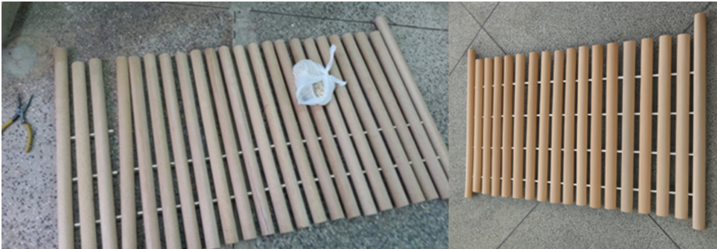
Figura 130. Proceso del armado del asiento de la silla prototipo La Petite
