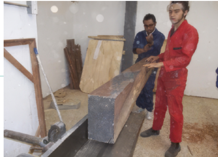
Figura 69. Canteado del canto de un bloque de madera maciza con máquina planeadora
