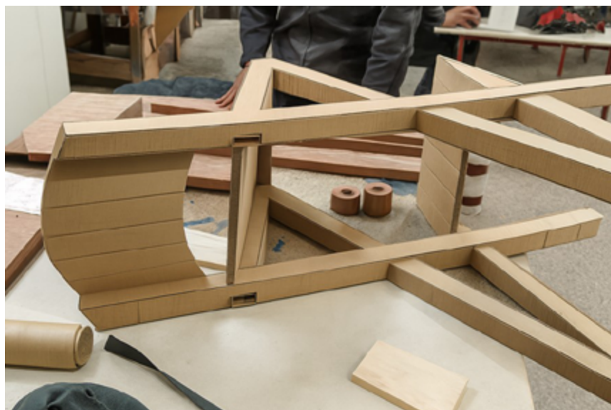
Figura 29. Modelo a escala 1:1 de la silla prototipo Alta, hecho con cartón en desarrollos prismáticos
