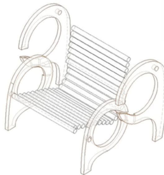
Figura 99. Vista explosionada de la silla prototipo La Petite
