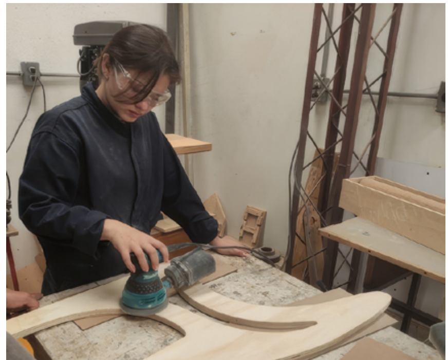
Figura 114. Lijado de una parte del prototipo de una silla con lijadora rotoorbital
