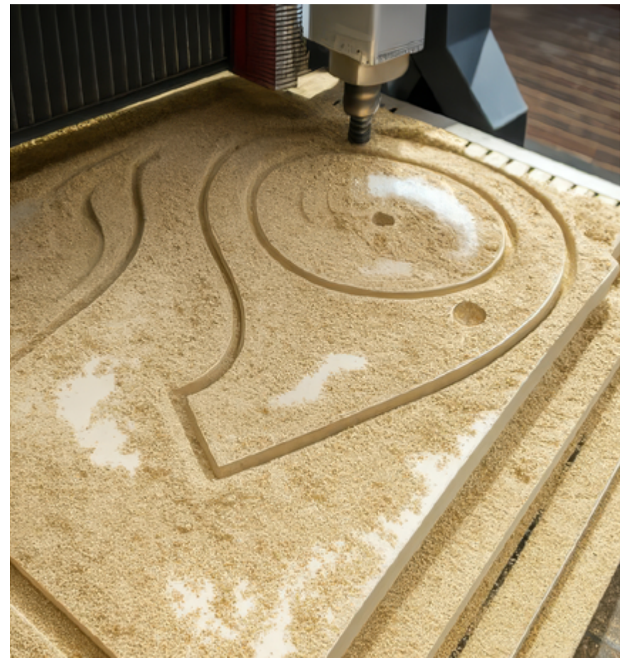
Figura 97. Parte de la elaboración del prototipo de silla La Petite mediante una máquina ruteadora CNC SUDA 1212
