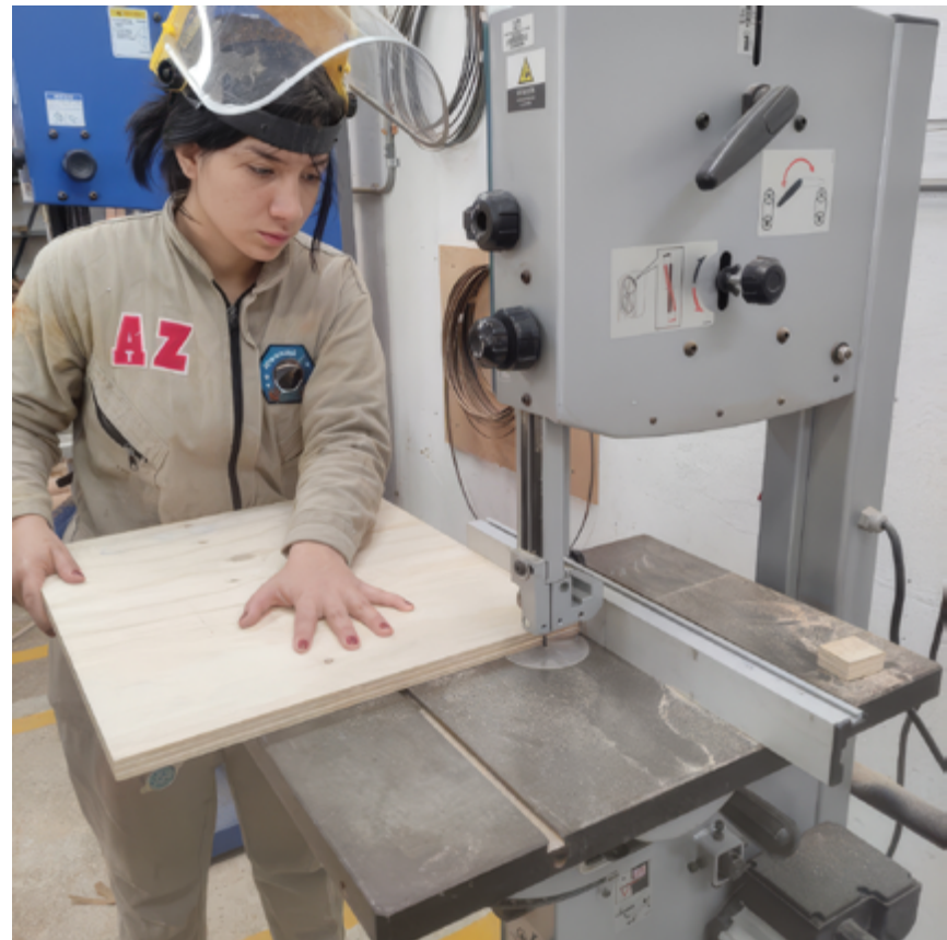
Figura 113. Corte con sierra sin fin de una cavidad del asiento de la silla prototipo Playita
