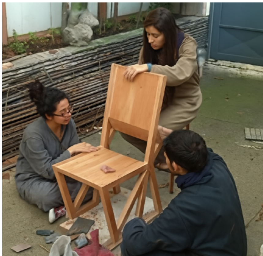
Figura 139. Lijado de la silla prototipo Elysian después del armado
