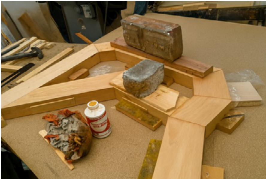
Figura 132. Artilugio para el armado de la silla prototipo Ro
