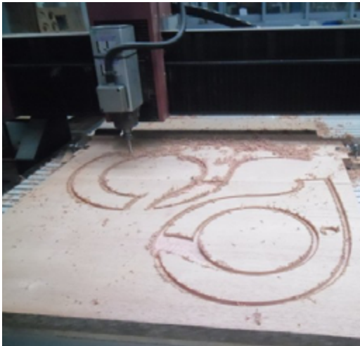
Figura 105. Ruteado de las partes de las patas en pino hayuelo para la silla prototipo La Petite
