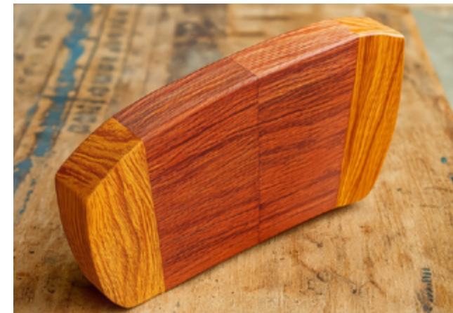
Figura 84. Ensamble a tope en una parte de una silla hecho solo con adhesivo
