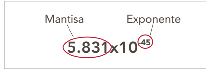
Figura 2.8. Representación de un valor tipo flotante (float).
