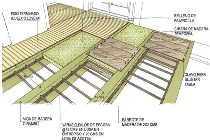
Figura 4. Partes del entrepiso de pajarilla.
