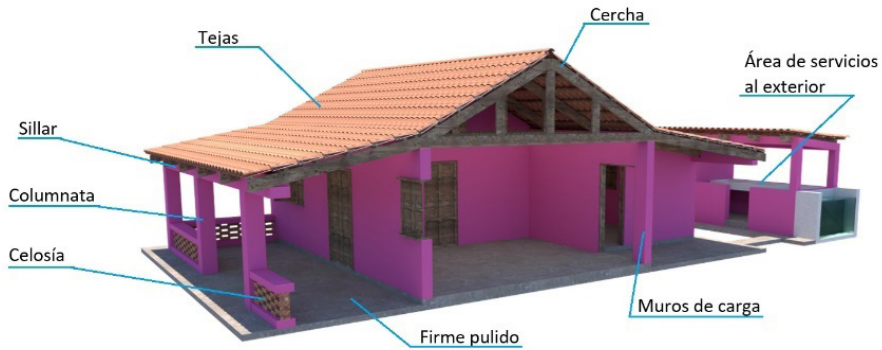
Figura 7. Sección de elementos constructivos de la Casa Rosa.
