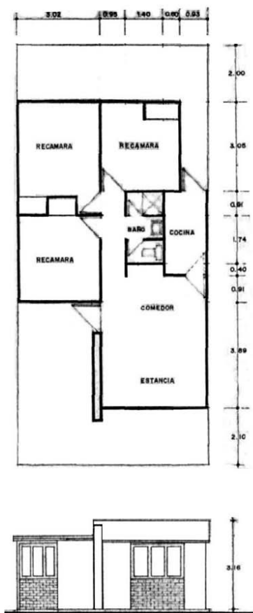
Proyecto de vivienda tipo (C3R), planta y fachada principal del fraccionamiento «Jardines de Zapotlán».
