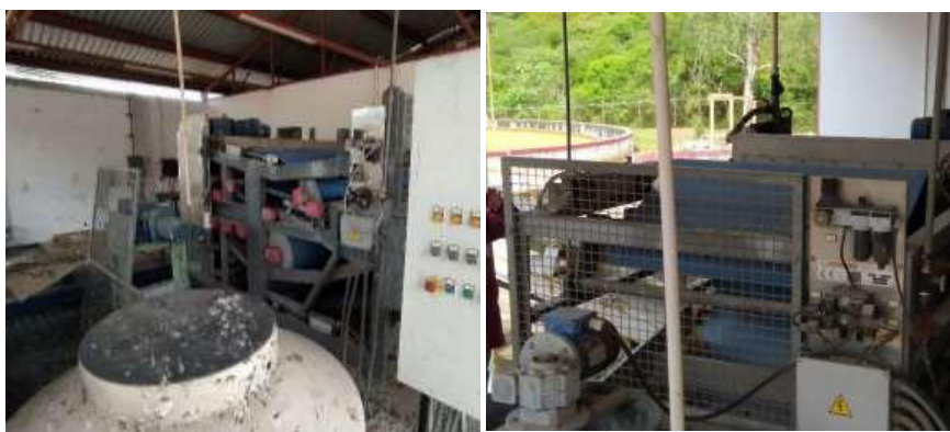
Figura 31. Instalaciones para tratamiento de lodos biológicos. Fuera de operación y en deterioro constante. Elaboración propia.
