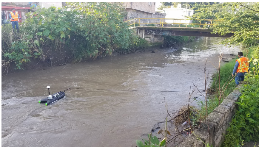
Figura 4. Medición del caudal en la estación hidrométrica NAY05. La línea punteada blanca indica la trayectoria del sensor (hidrobote), la flecha blanca indica la dirección del sensor y la flecha azul la dirección del agua. Fuente. Elaboración propia.
